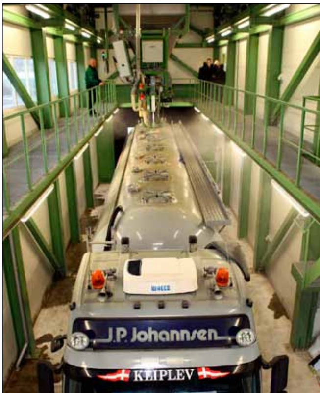
En robotvægt kan hente produkter fra 27 forskellige siloer og læsse de store lastbiler på den nye terminal hos Vitfoss.
