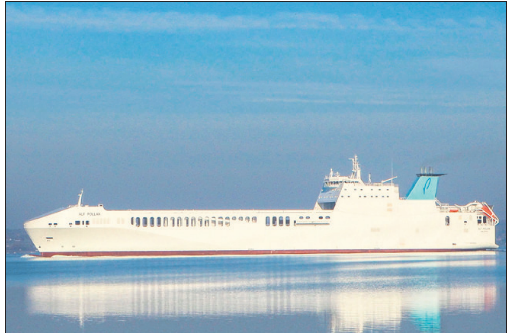
Skibets længde er på 209.79 meter. Bredden er 26.0 meter og den stikker 5.60 meter i vandet.
